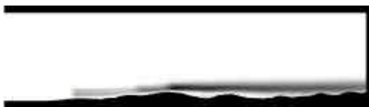
図 2 風車のウェイクによる風速減衰分布(断面図, 図 2 の A-B 断面)
